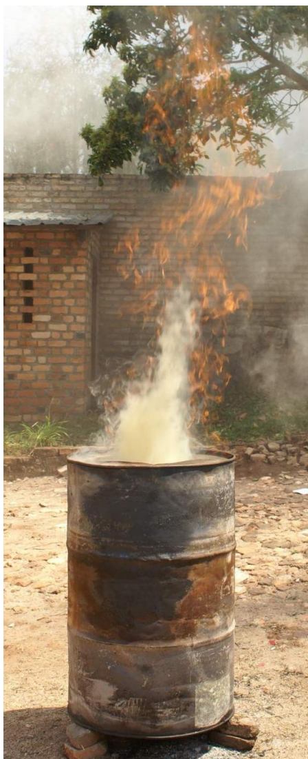
Photo n° 2 : Lorsque la fumée noircit, y mettre le feu avec précaution.
