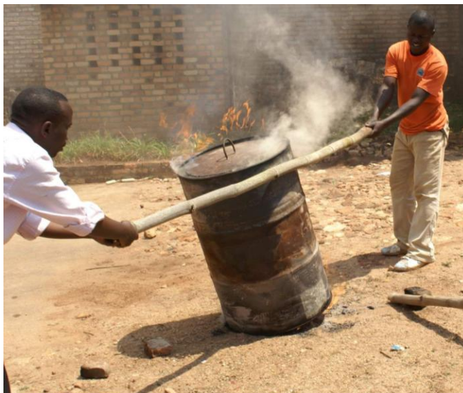
Photo n° 3 : Abaisser doucement le bidon obturer les trous d'air au fond.
