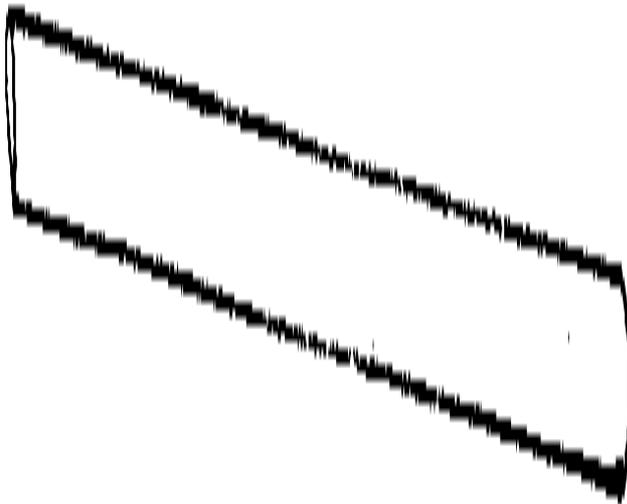
Um (1) arredondou pedaço de madeira, a largura, do loom. Para teares entre 30 e 60cm largo, deveria ser aproximadamente 4cm dentro diâmetro; para teares entre 60 e 120cm largo, 8cm em diâmetro; para teares entre 120 e 180cm largo, 12cm em diâmetro, e assim por diante. Increase 4cm para todo 60cm em largura.
