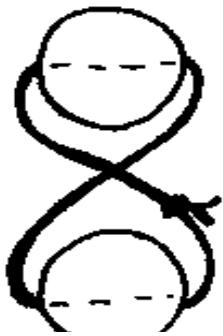
que usa um knot. quadrado Isto se manterá unido as varas e lhes impede de deslizar lateralmente.
